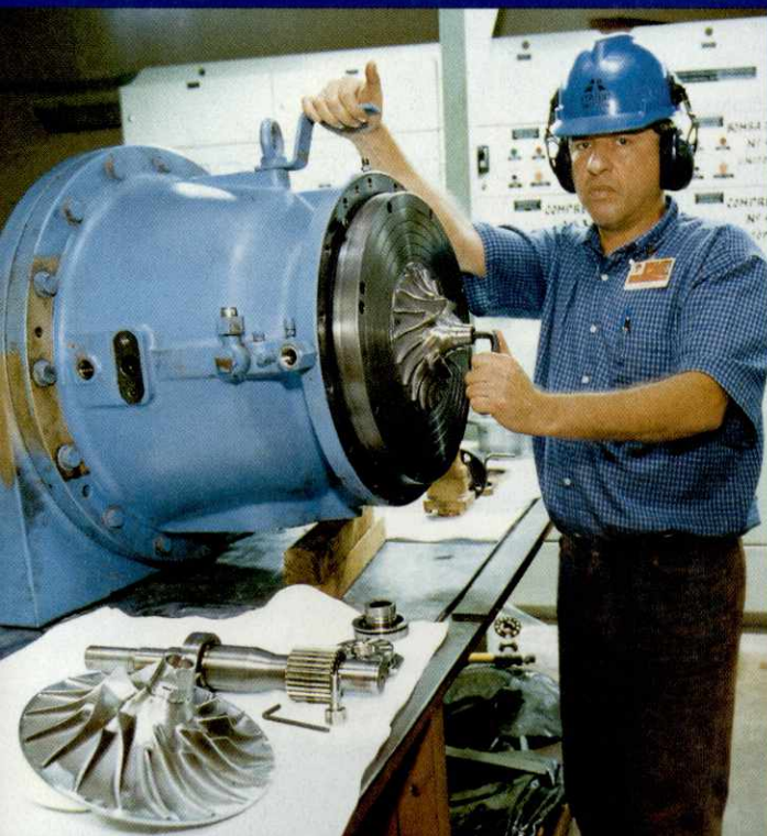
Técnico prepara a substituição do rotor do compressor para adaptar o equipamento ao novo tipo de gás.
