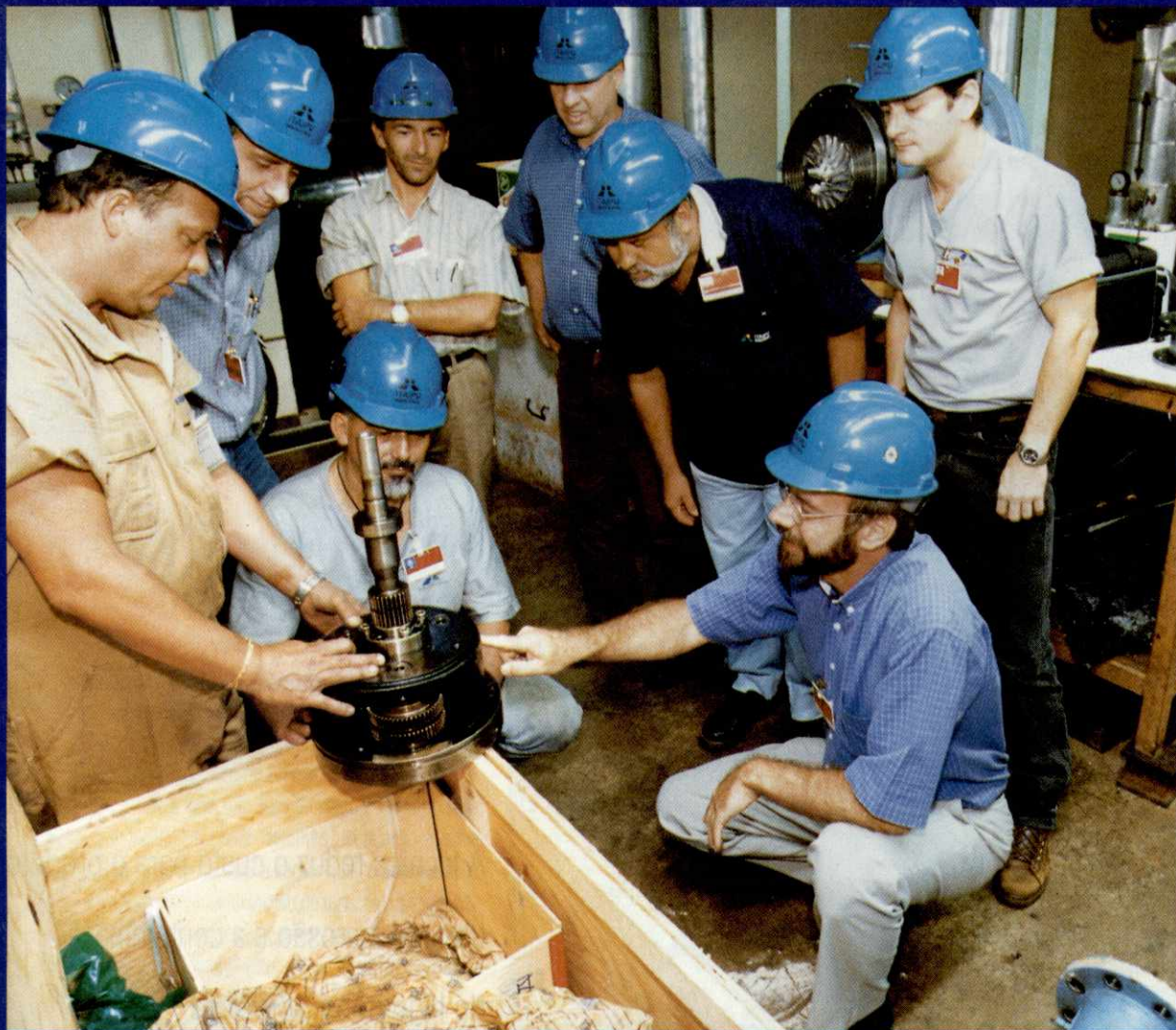
Engenheiros e técnicos examinam peça do compressor que será substituída.
