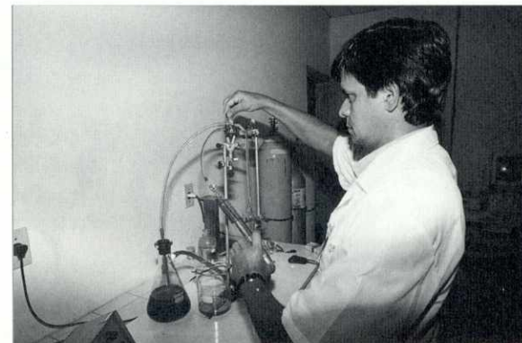
O técnico químico Julio Cesar Forneron inicia o processo para retirar os gases da amostra de óleo.
