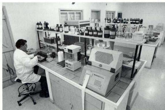
Vicente Roa Villamayor, técnico em Química, entre frascos e aparelhos verificando o índice de umidade do óleo.
