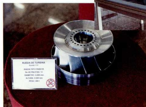
Outra maquete em exposição no hall do Edifício da Produção é a da roda de uma turbina, feita pela empresa Mecânica Pesada.
