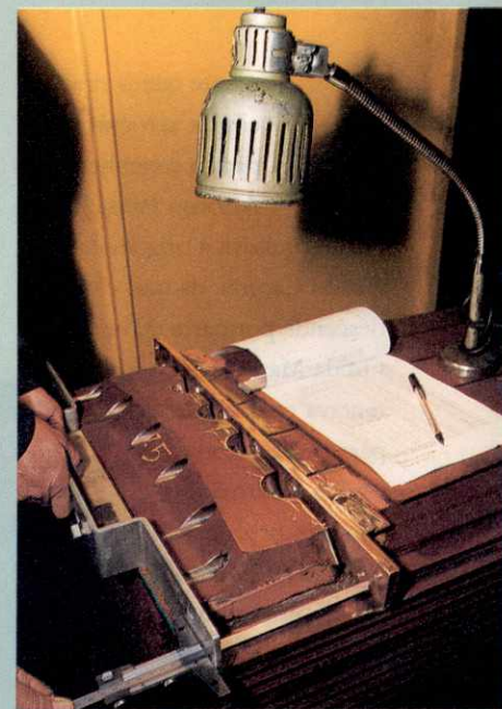
Depois de pronto, o pólo restaurado passa por um controle para protocolar as dimensões da peça a fim de permitir um acompanhamento futuro do serviço realizado.
