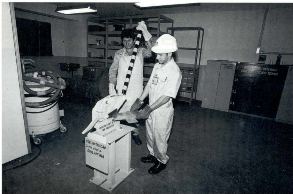
A guilhotina recebeu pintura especial na alavanca móvel, para que a atenção seja redobrada.
